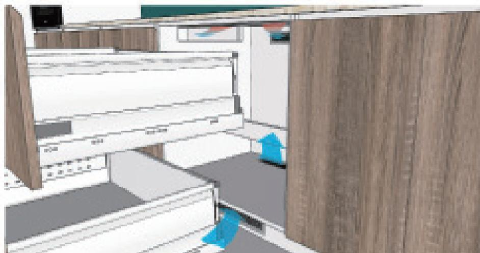
側腳板、尾板及背板開孔面積每孔 $270\text{cm}^2$ ，保持通風淨潔區域暢通
