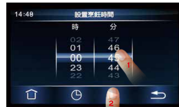
3. 上下滑動觸控面板選擇所對應時及分(24小時制)，觸控 ▶ 即開始烹調。
