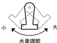
3. 若水量調節鈕至最小時，熱水仍不熱，表示水壓過高，需調整冷水源頭的三角凡爾，以控制較小的水量，但仍須配合燃氣壓力、火力調節鈕及水量調節鈕做適當調節，以避免熱水溫度過高產生蒸氣。
