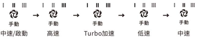
(1)Turbo加速運轉設定維持6min後，自動切換至高速持續運轉。
