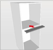
如圖所示將固隔保護鋼板放置於固隔層板
