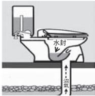
馬桶內的水分蒸發，產生水封破壞現象。
