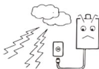
因由雷電產生之瞬間高電壓會損傷電子零件，雷電產生時，請迅速將電源插座頭從插座上拔除。
