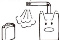
熱水器及排氣管附近請勿放置石油、汽油等起火物品及易燃物。
