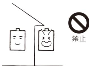
如果安裝場所有淋雨現象，請做遮雨設施，以確保機器能正常使用。另，屋內設置型不可裝設在浴室內。
