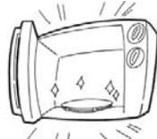
可用蘸有軟性洗滌劑(如洗潔精)的布類擦拭微波爐外殼，並用微濕布擦淨，然後再用乾布擦乾，保持爐腔的干爽。不要使用粗糙擦洗劑或鋒利的金屬刮刀清潔微波爐門的玻璃，如果微波爐門的玻璃表面擦傷，會導致玻璃粉碎。
