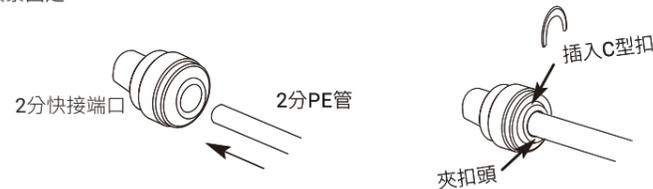
⚠ 注意：請務必加裝C型扣，確保管路緊密，以降低漏水狀況發生。
