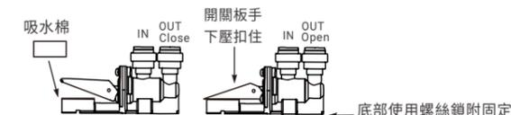
⚠ 漏水斷路器功能：當廚下水路漏水時，吸水棉吸附到3~5 ml的水後膨脹，使開關彈起遮斷水路。
